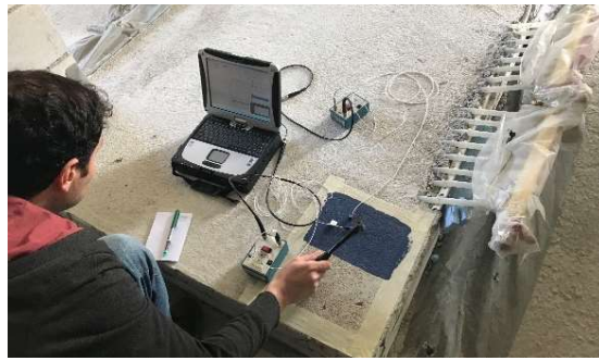
Şekil 11. Ayak sesi kaynaklı yapı yollu gürültünün saha ölçümü düzeneği
