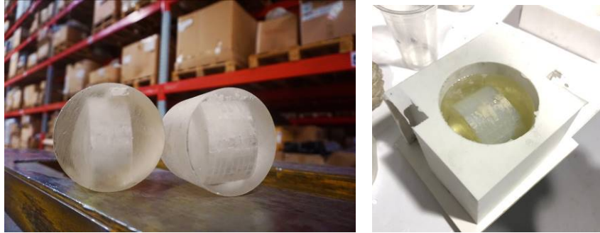
Şekil 3. GR ve WL numuneleri empedans tüpündeki ölçümler için hazır (solda), etrafına epoksi döküldükten sonra kalıpta kuruması beklenen WL prototipi (sağda)
