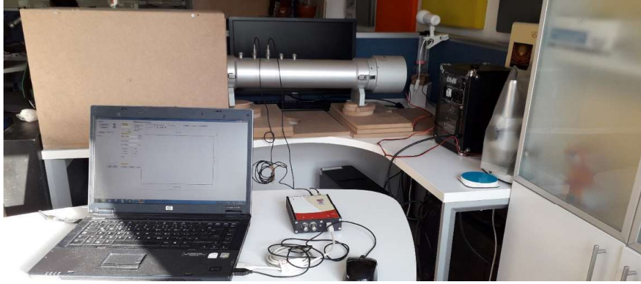
Şekil 2 Empedans tüpü deney düzeneği
