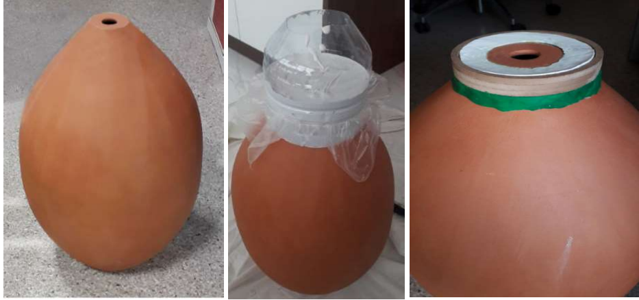
Şekil 3 Empedans tüpünde kullanılmak üzere üretilen numune (sol), bağlantı elemanı için alçı kalıp çıkarılması (orta) ve MDF halkalarla tamamlanan bağlantı elemanı (sağ)
