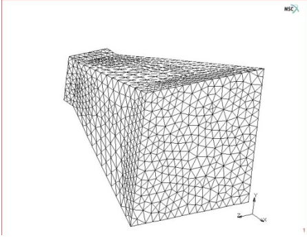
Şekil 2. Katlanmamış konik boynuz sonlu eleman modeli
