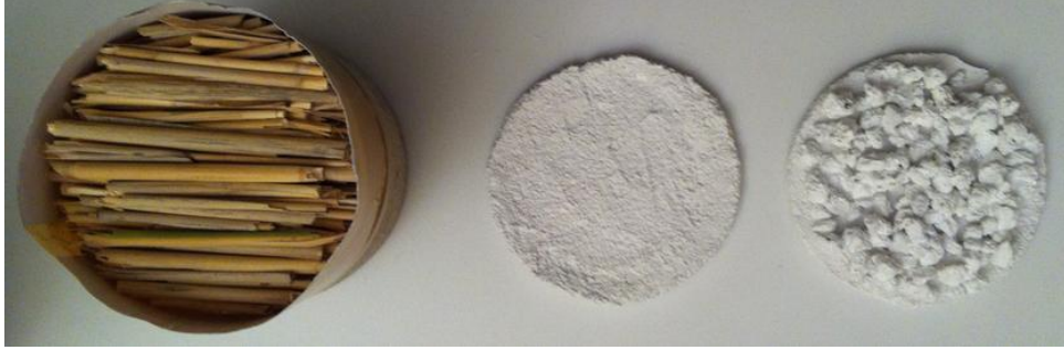
Şekil 5. Saz bitkisi, ponza sıva üst katmanı, ponza alt katmanı
