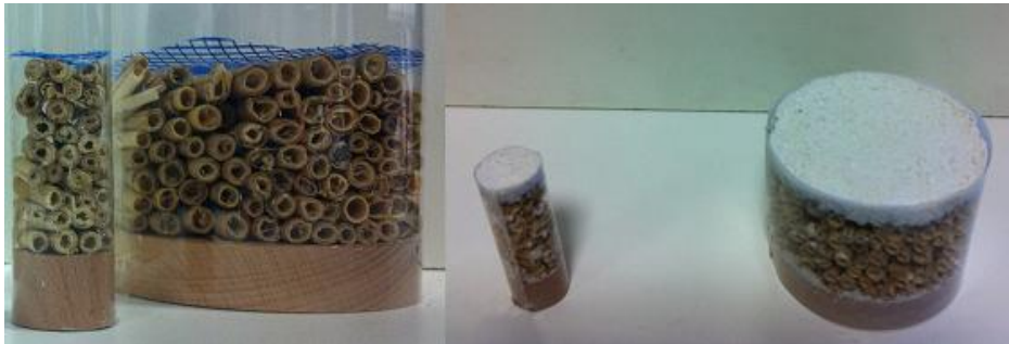
Şekil 6. Saz bitkisi, sıva teli ve sıva katmanları
